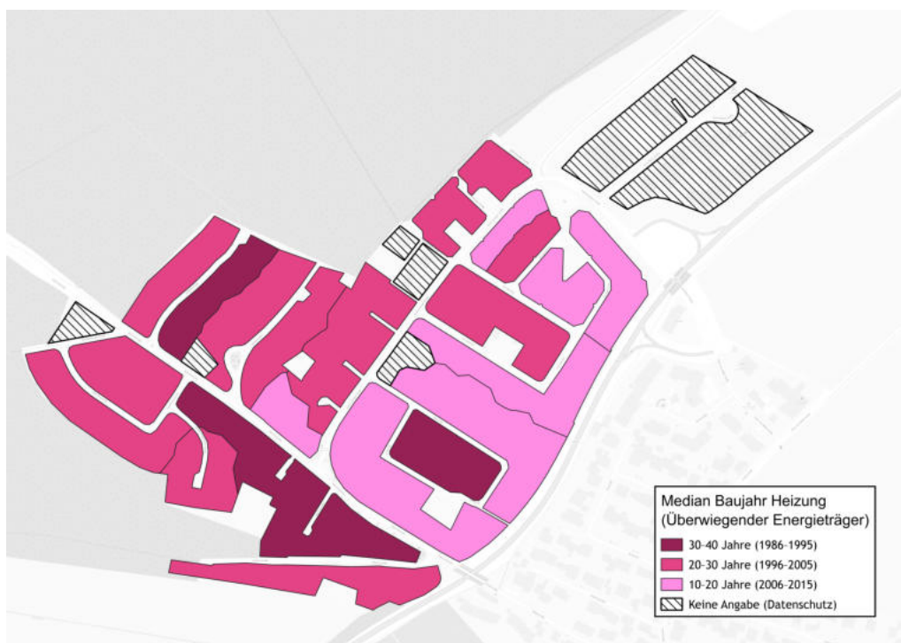
Abbildung 5.10: Heizungsalter im Fokusgebiet Schöngeising Nord auf Baublockebene, eigene Darstellung, Hintergrundkarte [1]
